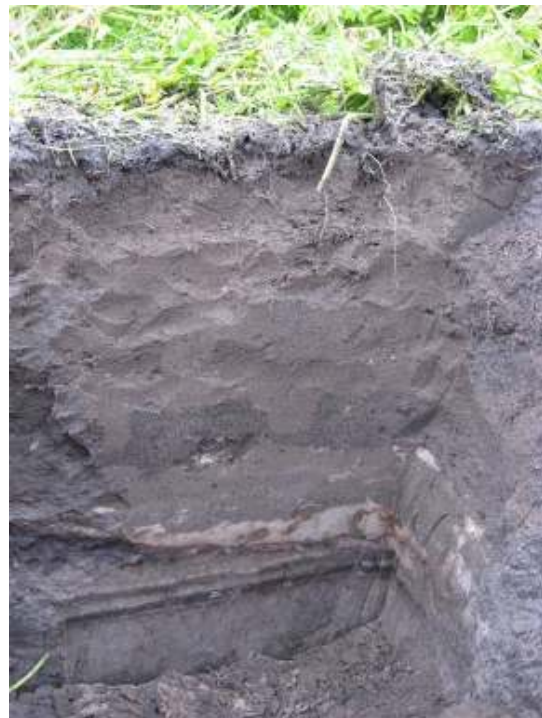
De bodem onder het perceel Gele mosterd. De bodem is sterk verdicht en belemmert de groei van wortels. De bodems op zandgronden in het noorden van Noord-Holland zijn gemiddeld slechter dan die in de duinstreek van Zuid-Holland. Een belangrijke reden is dat de gronden in het noorden korter in cultuur zijn.
