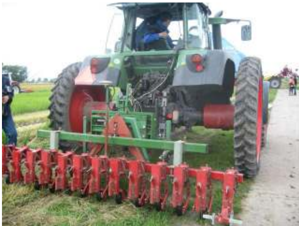
Trekker voor werken op vaste rijpaden op 3,20 m afstand tussen de wielen op een biologisch bedrijf bij Ens.
